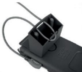
Beim Betrieb mit Kabelanschluss und Verwendung der Ablage sollte das Kabel gegen Zug entlastet werden. Führen Sie das Kabel wie im Bild gezeigt durch die dafür vorgesehenen Öffnungen des Aufsteller-sockels.
