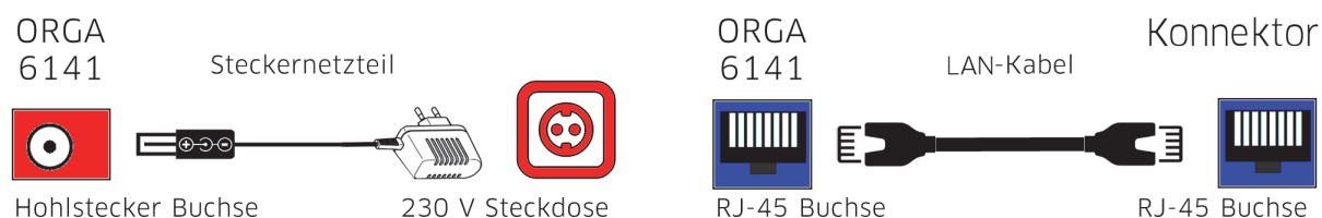
Abbildung 3: Anschluss mit LAN-Kabel am Konnektor
