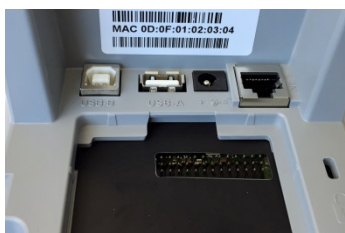
Abbildung 2: Geöffnetes Gerät mit Anschlussfeld und Bohrschutzfolie
