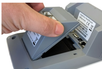
Abbildung 3: Aufsetzen des PoE Moduls
