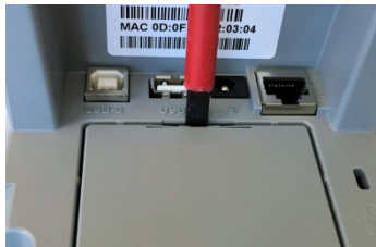
Abbildung 1: Entfernen der Klappe
